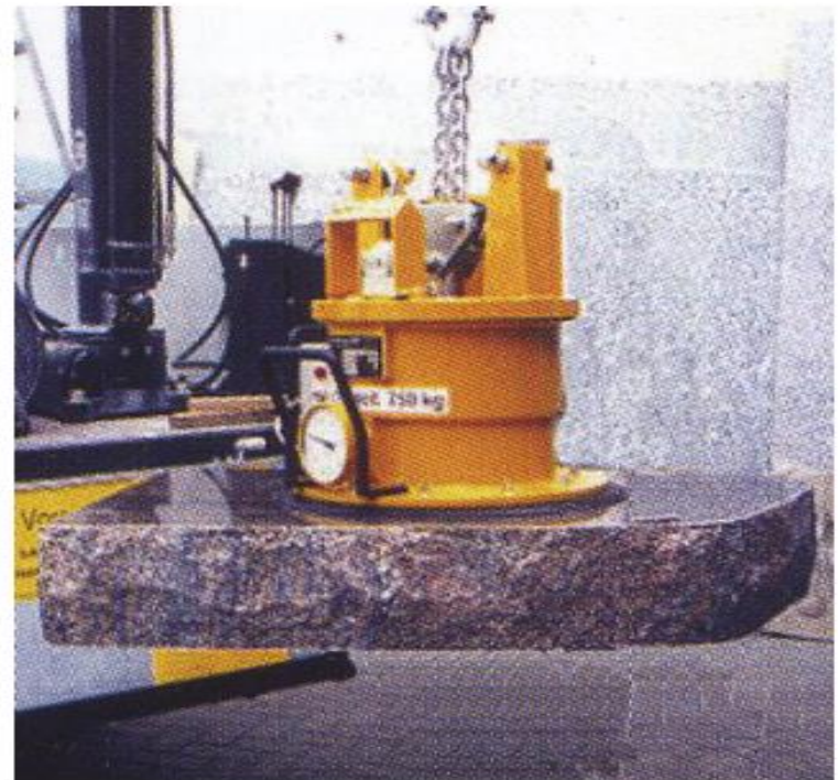
Sollevatore a depressione autoinnescante
