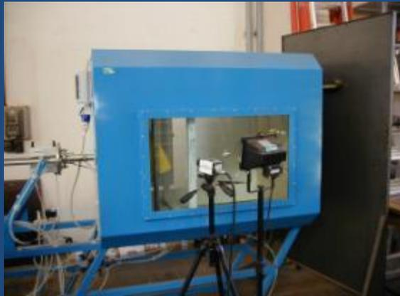
1. *un dispositivo ad aria compressa per la prova di impatto con proiettili di vario calibro*
