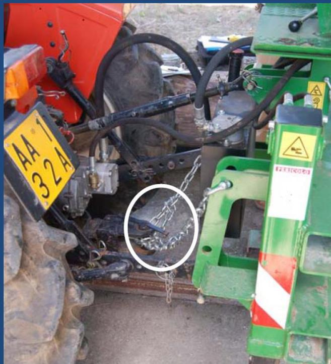
Al fine di evitare il moto relativo fra retroescavatore e trattore sono generalmente previsti dei dispositivi (tiranti o catene) che l'operatore deve applicare fra trattore e retroescavatore.
