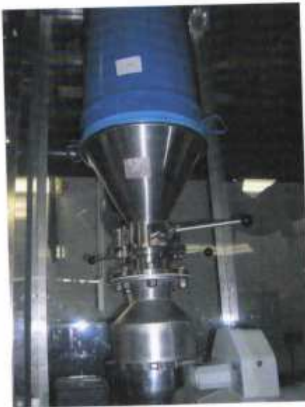
Transfert des NTC par vanne sécurisée
