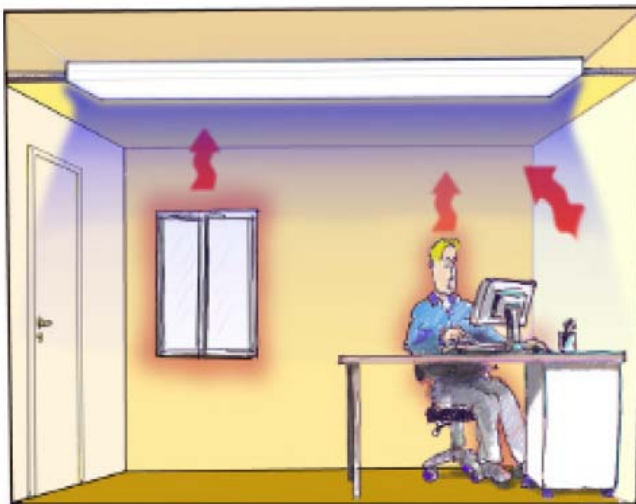
Fig. 1 Soffitto freddo / Trave fredda in raffrescamento
