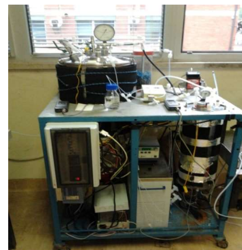
Sistemi sperimentali (50 l volume) per la produzione di H 2 e metano con sistema two stages
