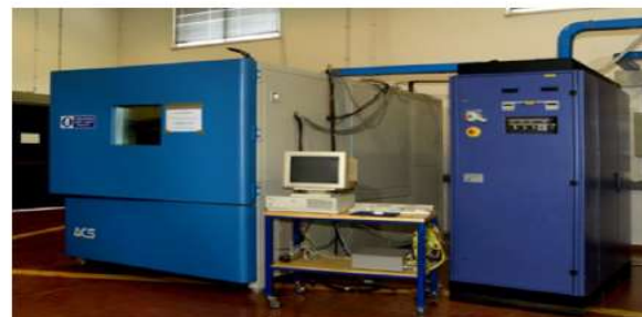
Laboratorio prova Batterie (ciclatori e camera climatica)
