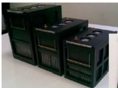
Moduli di batterie 12V/ 30/60/120 Ah e scheda di controllo
