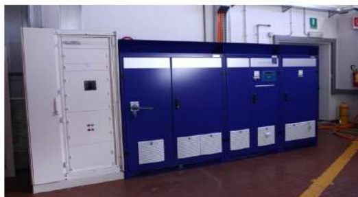
Laboratorio prova Batterie (ciclatori e camera climatica)
